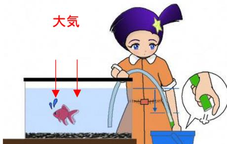
図 3.3 サイフォンの原理を利用事例 (水槽の水替え)
