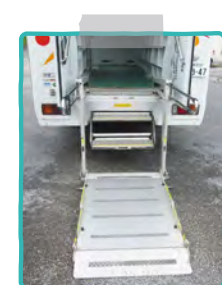
▲初代にはなかった車いす用のリフト
