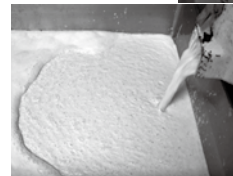
◀摩砕は水を注ぎながら行いますが、この時の水分量によって豆腐の濃度に違いが生じます。
